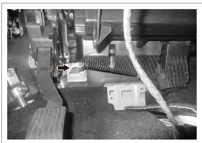
17. 拆下空调器总成左下侧 1 个螺母
