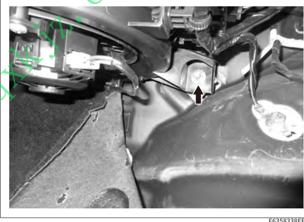
20. 断开空调加热器线束接插件
